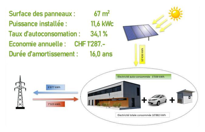
Fig. 13 – Schéma de la production et de la consommation annuelles d'électricité en 2021
